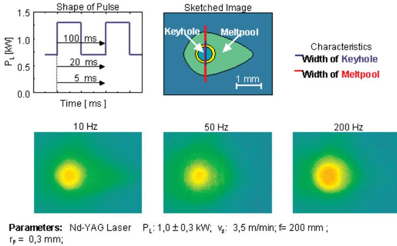
**Parameters:** Nd-YAG Laser  $P_L: 1,0 \pm 0,3 \text{ kW}$ ;  $v_g: 3,5 \text{ m/min}$ ;  $f = 200 \text{ mm}$ ;  $r_f = 0,3 \text{ mm}$ ;
