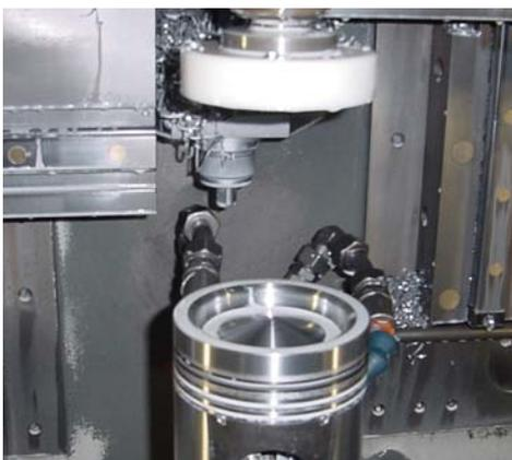
Speziell beim Drehen der Bodenmulde kann es zu einem Spänestau kommen, der dann zum Werkzeugbruch führt. PROSIN wird zur Werkzeugbruchüberwachung und zum Schutz gegen statische Überlast eingesetzt.
